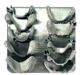
Avec son volume de fabrication et sa source laser de 500 W, cette imprimante 3D de métal permet de réduire le coût par pièce et de raccourcir les délais de livraison. Sa capacité à imprimer avec moins de supports, avec une finition de surface visiblement meilleure, permet de réduire le post-traitement et la consommation de matériau.
